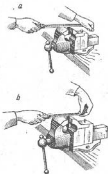
Joon. 269. Käte asend viilimisel. a — jämeviilimisel, b — peen- viilimisel.
