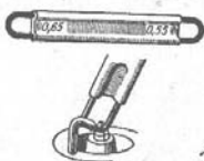
Joon. 321. Süüteküünla elektroodide vahe kontrollimine ja reguleerimine.
